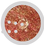
Sección de alambre de cobre con núcleo de oro
