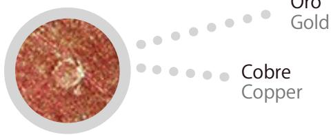
Sección de alambre de cobre con núcleo de oro
